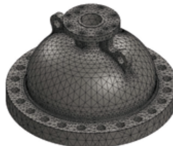
MALLA DE ELEMENTOS FINITOS UTILIZADA EN LOS ESTUDIOS DE OPTIMIZACIÓN
