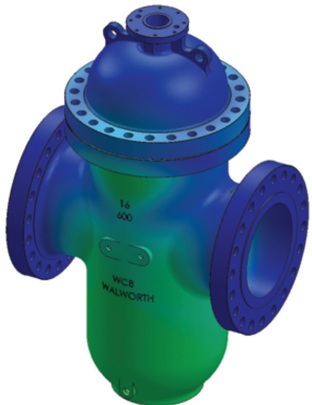
SECCIÓN CENTRAL DEL CUERPO BAJO MOMENTOS APLICADOS DE FLEXIÓN
